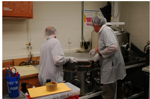
(d) Installing the base plate in the chamber
