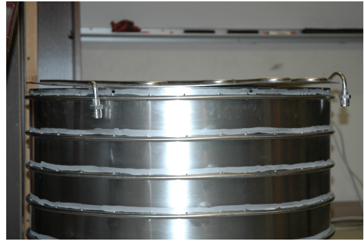
(d) Warped Shroud Top
